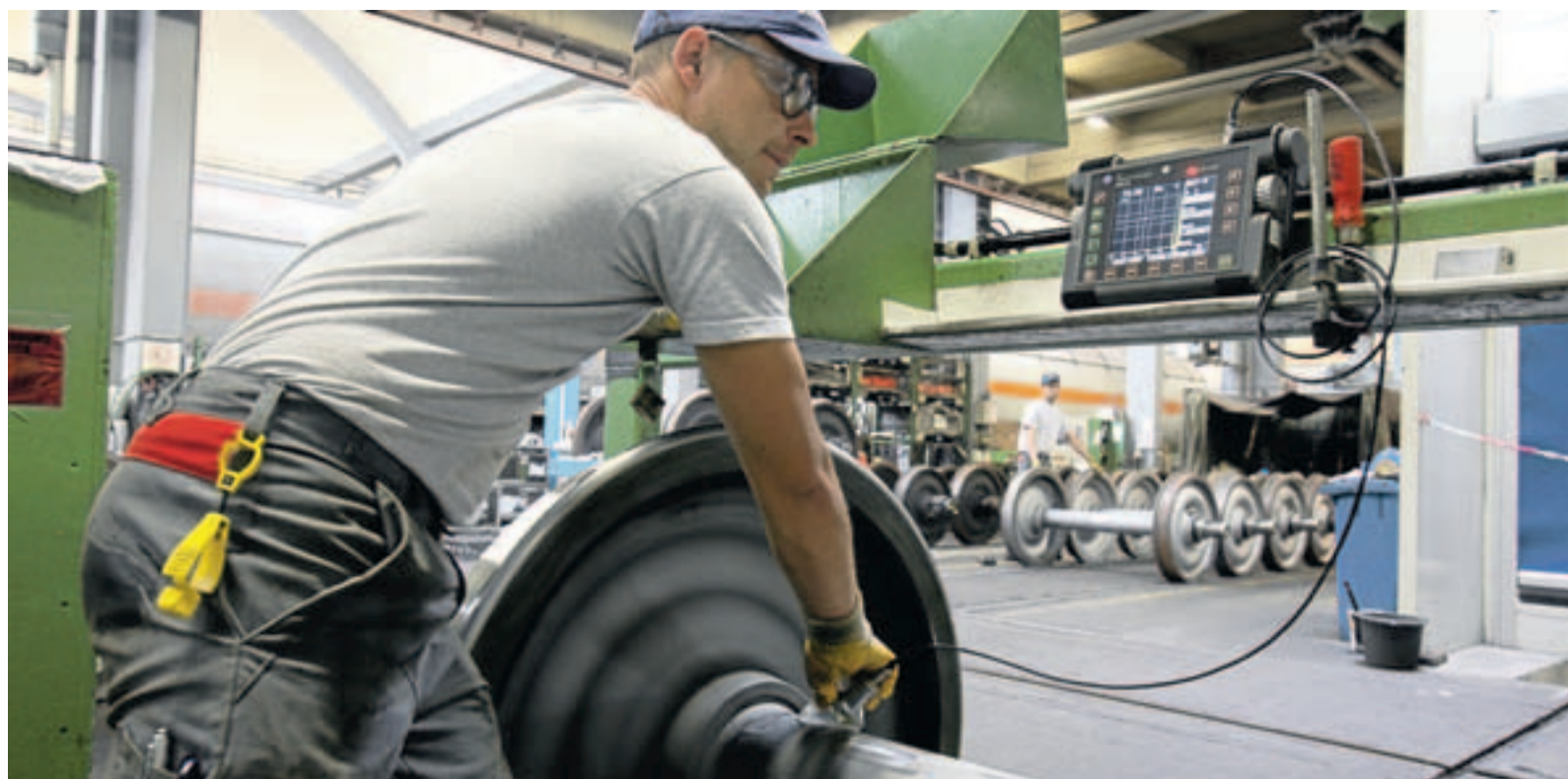
Ultraschallprüfung einer Waggon-Welle im Instandhaltungswerk von Alstom in Salzgitter.
