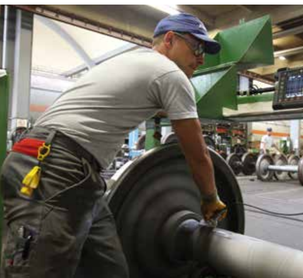
Ultraschallprüfung einer Radsatzwelle im Instandhaltungswerk des Schienenfahrzeugherstellers Alstom in Salzgitter.
